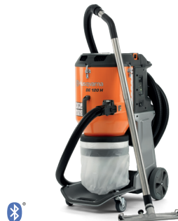
ALIMENTARE ELECTRICĂ HUSQVARNA DE 120 H 2.2kW, 230V, monofazic, 15A, 480m³/h, 39kg, IP55.
