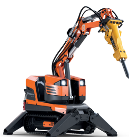
HUSQVARNA DXR 95 9.8 kW, 589 kg, rază de acțiune 3.2/2.7 m sus/ înainte inclusiv picon.
