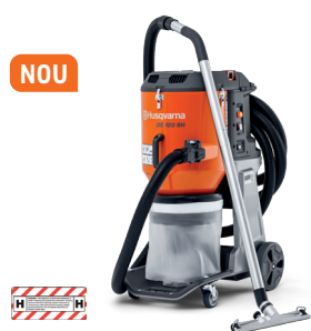
ALIMENTARE ELECTRICĂ HUSQVARNA DE 120 SH 1.8kW, 230V, monofazic, 8A, 430m³/h, 39kg, IP55.
