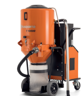
ALIMENTARE ELECTRICĂ HUSQVARNA T10000 11kW, 400V, trifazic, 32A, 900m³/h, 336kg.
