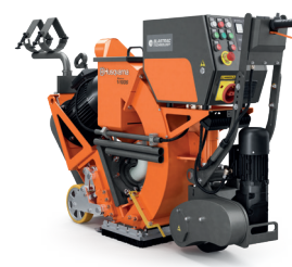
ALIMENTARE ELECTRICĂ HUSQVARNA BLASTRAC 1-10DS 11kW, 400V, 32/63A, viteză de lucru 0.5–25m/min, lățime de lucru 254mm, 395 kg.
