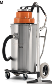
ALIMENTARE ELECTRICĂ HUSQVARNA W 70 1.2kW, 230V, monofazic, 5.2A, 200m³/h, 32kg.
