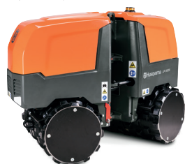
ALIMENTARE DIESEL HUSQVARNA LP 9505 18 kW, lățime tambur 850 mm, 1680 kg, forță centrifugă 72 kN.
