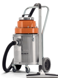
ALIMENTARE ELECTRICĂ HUSQVARNA W 250 P 1.55kW, 230V, monofazic, 5.2A, 160m³/h, 26kg.
