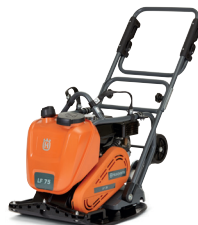
ALIMENTARE PE BENZINĂ HUSQVARNA LF 75 LAT 3.6 kW, 420–500 mm, 95–97 kg, forță centrifugă 15 kN.
