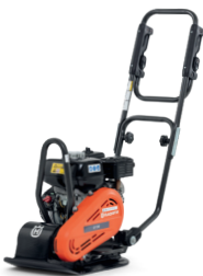
ALIMENTARE PE BENZINĂ HUSQVARNA LF 50 L 3.6 kW, 320 mm, 56 kg, forță centrifugă 8.4 kN.
