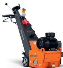
ALIMENTARE ELECTRICĂ HUSQVARNA BMP 265 5.5 kW, 400V/16A, 265 mm lățime de lucru, 175 kg.
