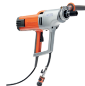
ALIMENTARE ELECTRICĂ HUSQVARNA DM 230 1850 W, monofazic, diametru recomandat carotă 150 mm, manual 80 mm, 7 kg.
