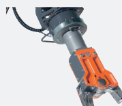
HUSQVARNA DSS 200 Foaie metalică pentru demolarea structurilor, conductelor, vaselor de proces și rezervoarelor. Ideală în zone sensibile, precum industriile de proces. Pentru Husqvarna DXR 315, DXR 305, DXR 275 și DXR 145.
