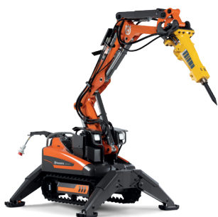
HUSQVARNA DXR 145 18.5 kW, 1040 kg, rază de acțiune 4.4/3.7 m sus/înainte inclusiv picon.
