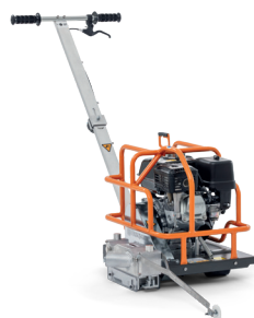
ALIMENTARE PE BENZINĂ HUSQVARNA SOFF-CUT 150 Disc diamantat max 165 mm, adâncime de tăiere max 38 mm, 40 kg, 3.5 kW*.
