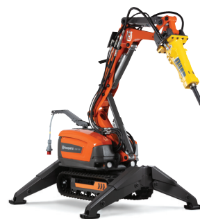
HUSQVARNA DXR 275 24 kW, 1850 kg, rază de acțiune 4.8/4.5 m sus/ înainte inclusiv picon.
