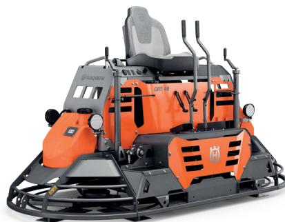
ALIMENTARE PE BENZINĂ HUSQVARNA CRT 48 Ideal pentru finisarea suprafețelor 1000–2000 m². Dispune de un sistem de direcție mecanic superior și de un raport putere-greutate echilibrat. 27.6 kW, 2×1220 mm, 579 kg.
