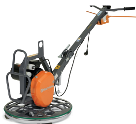
ALIMENTARE ELECTRICĂ HUSQVARNA BG 245 E 1.5 kW, 600 mm, 60 kg.
