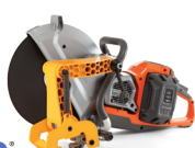
MAȘINĂ DE TĂIAT CU DISC HUSQVARNA K1 PACE RAIL 7.9 kg, diametru disc 356 mm, adâncime de tăiere 133 mm, platforma de baterii PACE 94V.
