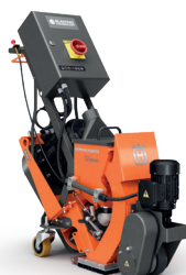
ALIMENTARE ELECTRICĂ HUSQVARNA BLASTRAC 1-8DPF40 4kW, 400V, 16A, viteză de lucru 0.5–23m/min, lățime de lucru 203mm, 122 kg.
