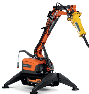
HUSQVARNA DXR 305 27 kW, 2050 kg, rază de acțiune 5.2/4.9 m sus/ înainte inclusiv picon.
