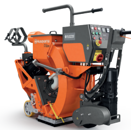
ALIMENTARE ELECTRICĂ HUSQVARNA BLASTRAC 1-15DS 15kW, 400V, 63A, viteză de lucru 0.5– 25m/min, lățime de lucru 380mm, 450 kg.
