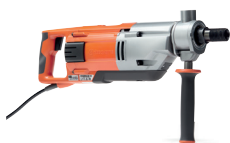
ALIMENTARE ELECTRICĂ HUSQVARNA DM 220 1850 W, monofazic, diametru recomandat carotă 150 mm, manual 80 mm, 7,5 kg.
