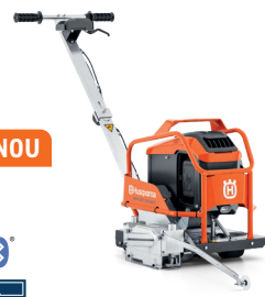
ALIMENTARE PE BATERIE HUSQVARNA SOFF-CUT 150 PACE Disc diamantat max 165 mm, adâncime de tăiere max 38 mm, 41 kg, 2.7 kW.
