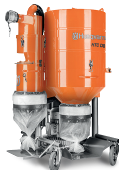
ALIMENTARE ELECTRICĂ HUSQVARNA HTC D80 7.5kW, 380–415V, trifazic, 16.7A, 700m³/h, 272kg.
