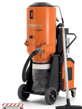
ALIMENTARE ELECTRICĂ HUSQVARNA T7500 5.5kW, 400V, trifazic, 12A, 600m³/h, 206kg.
