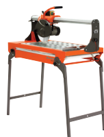
ALIMENTARE ELECTRICĂ HUSQVARNA TS 73 R 1000W, max Ø 230 mm, adâncime de tăiere max 50/100 mm, 47 kg.
